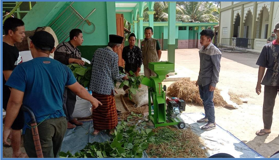
Gambar 2. Proses Penghancuran Dedaunan Menggunakan Mesin Pencacah
