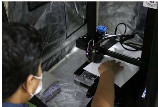
Gambar 1. Proses pencetakan model menggunakan teknologi 3D Printer tipe FDM pada tahap produksi prototipe
